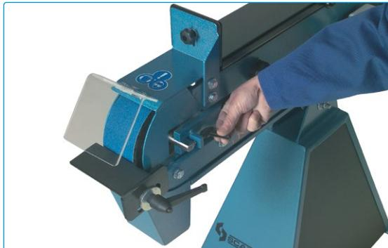
**FI** **Nauhan säätö** - tämä on erittäin tärkeä yksityiskohta kontaktilaikan käyttöön osalta. Nauhan liike säädetään kosketuspyörän akselin lähellä. Helpo tarkastaa ennen hionnan aloittamista.
