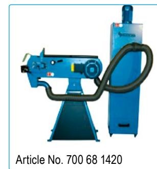
**FI** Täydennä pölynpoisto- ja suodatusyksiköön pyörre-erotonin, ilmanpoisto, kipinälaittikko ja polysuodatin.
