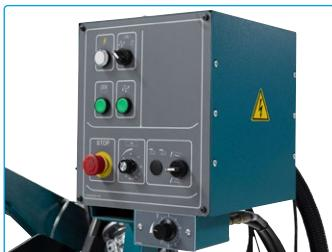
**FI** Uudella yhden kosketuksen ominaisuudella – sahanterä voidaan käynnistää vain yhdellä painalluksella. Saha liikkuu kohti työkappaleita ja syöttömekanismia säädetään automaattisesti haluttuun nopeuteen.
