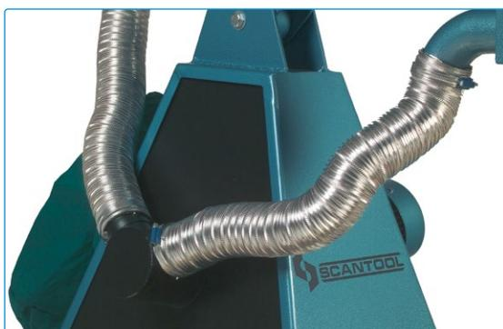
**FI** **Pölypussi** – kaikki integroidut imuilmajärjestelmät toimitetaan pölypussilla. Pölypussi on tyhjennettävä usein ja huolellisesti, jotta ilmanpoisto tapahtuisi mahdollisimman laadukkaasti.
