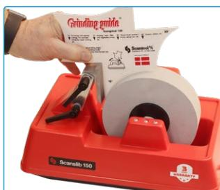
Säädä työkalupidin vaadittavaan hiontakulmaan tämän koneen ohjaimella. Nämä ovat lisävarusteita.
