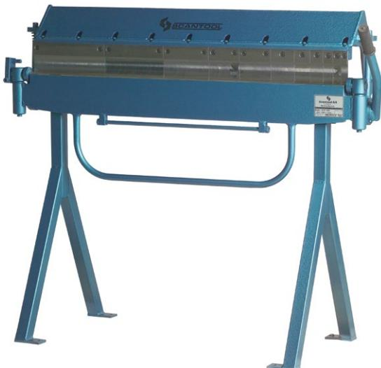
**FI** Scantool SCA/SCB/SCST -malleissa on erikoisrakenteinen yläpalkki, joka voi käsitellä eripaksuiset levyt ilman säättöä. Poikkeama on säädettävissä.
